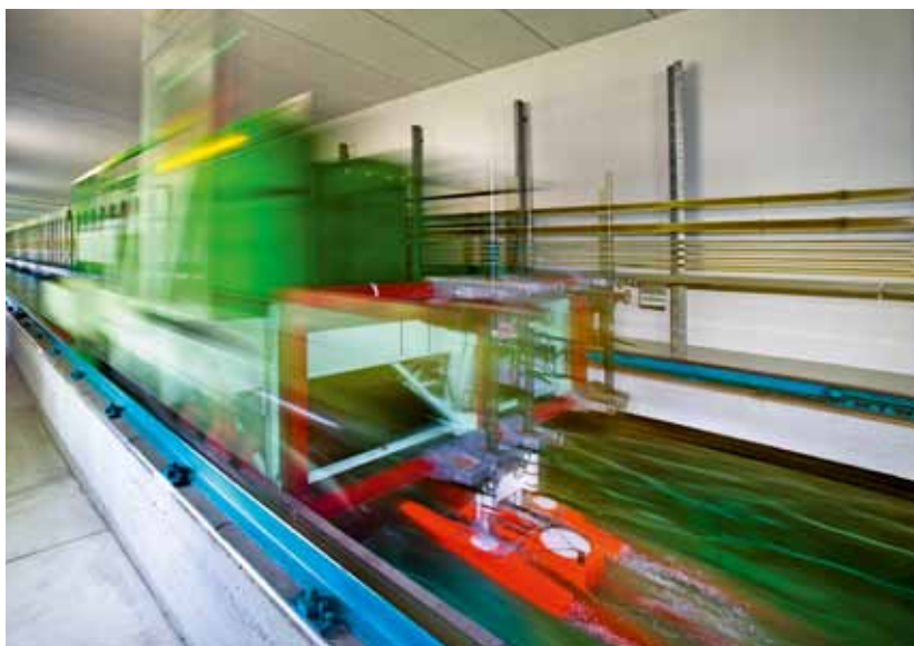
9 Conduite d'essai avec un Acoustic Doppler Current Profiler (ADCP).
