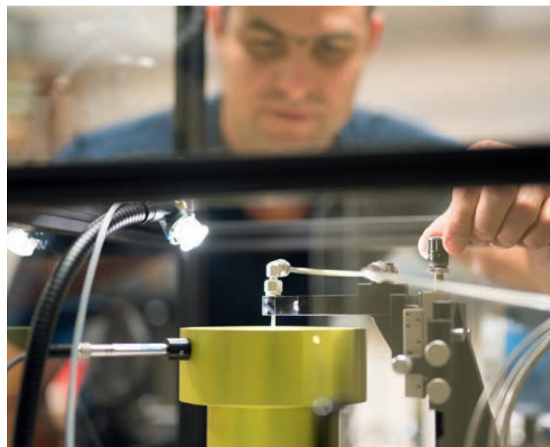
3: Bei der gravimetrischen Durchflussbestimmung wird die Austrittsnadel (A) knapp (50 µm) oberhalb des Glasfilters (C) positioniert. Durch die kapillare Saugkraft des Glasfilters entsteht bei jedem Durchfluss eine Wasserbrücke und damit der gewünschte kontinuierliche Fluss in den Messbecher (B).
