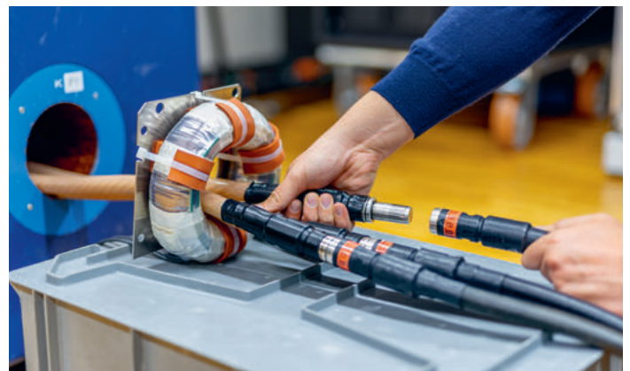
Kalibrierung von Messmitteln zur Bestimmung von Netzwerkparametern.
