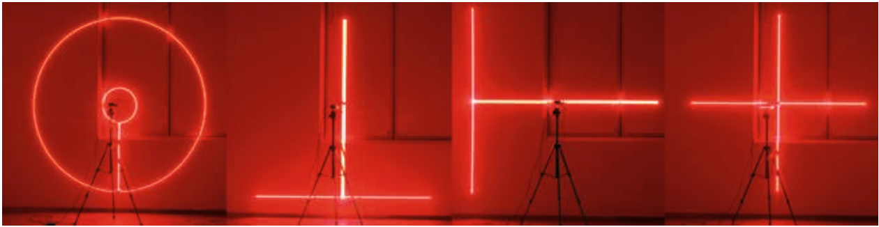
4 Ausrichtung des Lasers: zuerst wird das Feld um die Sonde positioniert. Dann wird mit einer automatischen Analyse X-Achse und Y-Achse gescannt. Bei den höchsten Werten wird das Fadenkreuz projiziert – die Charakterisierung des Lasers beginnt.
