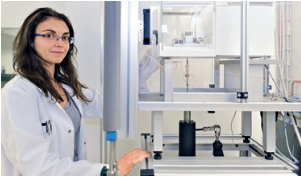
3: Céline Pascale kontrolliert die Gewichtsstücke der Magnetschwebewaage, die sich abwechselnd selbst kalibriert und die Substanzabgabe – im Bereich von Nanogramm bis Mikrogramm pro Minute – misst.
